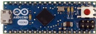
Gambar 10. ArduinoMicro (Kadir, Abdul. 2012. Scratch For Arduino Panduan Untuk Mempelajari Elektronika Dan Pemrograman)
