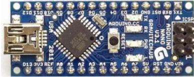
Gambar 8. ArduinoNano(Kadir, Abdul. 2012. Scratch For Arduino Panduan Untuk Mempelajari Elektronika Dan Pemrograman)
