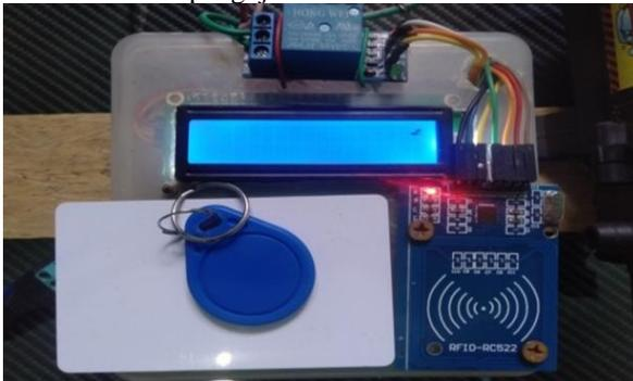
Gambar 15. Alat Pengaman Sepeda Motor Menggunakan RFID
