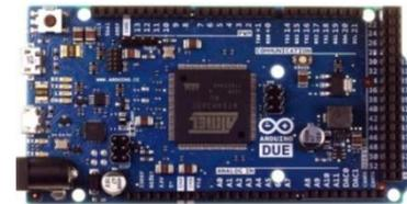
Gambar3. *ArduinoDue* (Kadir, Abdul. 2012. *Scratch For Arduino Panduan Untuk Mempelajari Elektronika Dan Pemrograman*)
