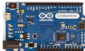
Gambar 5. *ArduinoLeonardo* (Kadir, Abdul. 2012. *Scratch For Arduino Panduan Untuk Mempelajari Elektronika Dan Pemrograman*)
