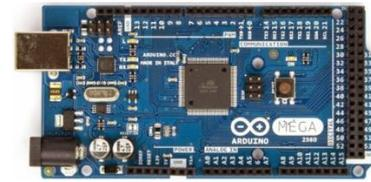
Gambar4. *ArduinoMega* (Kadir, Abdul. 2012. *Scratch For Arduino Panduan Untuk Mempelajari Elektronika Dan Pemrograman*)
