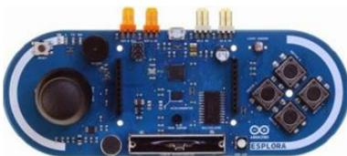
Gambar 12. ArduinoEsplora (Kadir, Abdul. 2012. Scratch For Arduino Panduan Untuk Mempelajari Elektronika Dan Pemrograman)
