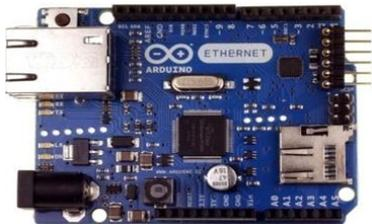
Gambar 11. ArduinoEthernet (Kadir, Abdul. 2012. Scratch For Arduino Panduan Untuk Mempelajari Elektronika Dan Pemrograman)
