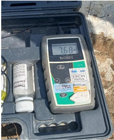
Gambar 4. Hasil pengukuran pH air di KPL tambang batupapur
