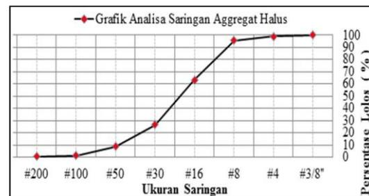
Gambar 3.3 Hasil analisa saringan agregat halus (*pasir*)
